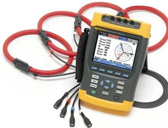
**Figura 6.1 – Analisador de QEE – Fluke 435**
