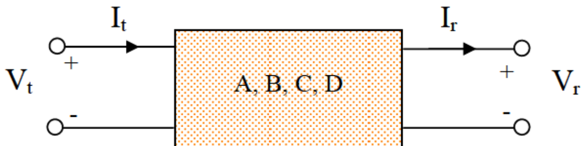
Figura 2.5- Linha de Transmissão como Quadripolo Fonte: [4]
